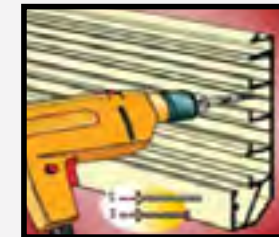
Goulotte à 4 compartiments : vissée ou collée
